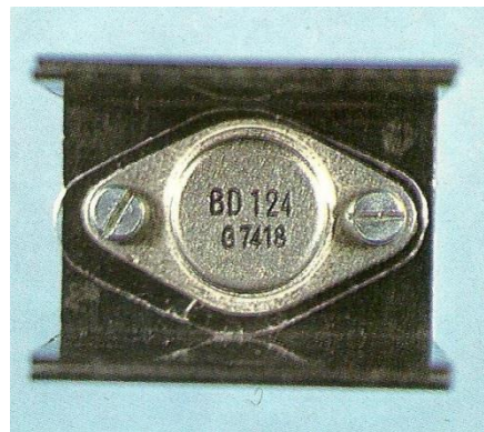
Disipador de mayor tamaño empleado para refrigerar un transistor con encapsulado TO3. Con lámina de mica aislante.
